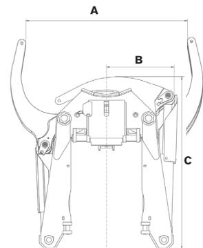
Verriegelung der Greiferkassette und Anschluss an die Hydraulik erfolgen durch den gleichen Handgriff mit einem 32-mm Ringschlüssel. Dadurch dauert das An- und Abkoppeln noch nicht einmal eine Minute.
